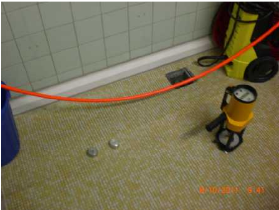
Bild 5: BPS Wenningsen Haftzugprüfvorrichtung zur Bestimmung der Haftzugfestigkeit der Betonoberflächen mit dem im Verbund hergestellten Mosaikfliesenbelag auf der Kellerdecke
